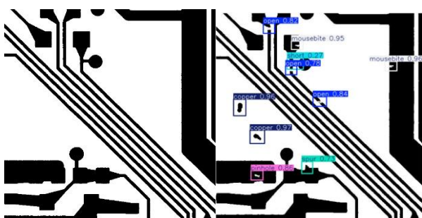
รูปที่ 6.4 ตัวอย่างผลลัพธ์การตรวจจับข้อบกพร่องบนภาพทดสอบที่มี Defect ที่เกิดใกล้กัน หรือชิดติดกันทำให้โมเดลมีความมั่นใจต่ำและต้องใช้ในการตรวจสอบด้วยสายตาอีกครั้งจึงจะสามารถตัดสินใจได้ว่าเป็น Defect หรือไม่
