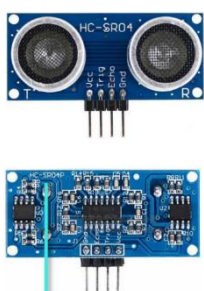
รูปที่ 3 อัลตราโซนิกที่นำมาใช้ตรวจจับระยะสิ่งกีดขวาง
