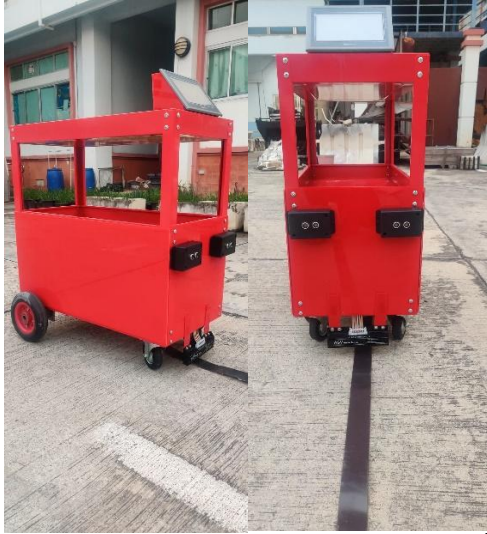
รูปที่ 6 หุ่นยนต์ขับเคลื่อนอัตโนมัติด้วยแผงเซลล์ที่พัฒนาขึ้น
