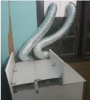
รูปที่ 5 เครื่องปรับอากาศ IoT ด้วยหลักการ Thermoelectric
