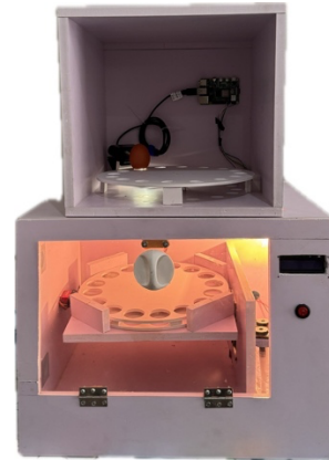
รูปที่ 4 ตู้สำหรับการตรวจสอบเชื้อในไข่ไก่และปักไข่ไก่ที่สร้างขึ้น
