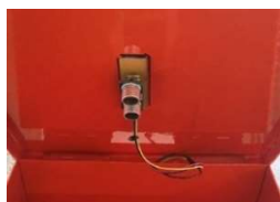
รูปที่ 2 การติดตั้งเซนเซอร์อัลตราโซนิก
