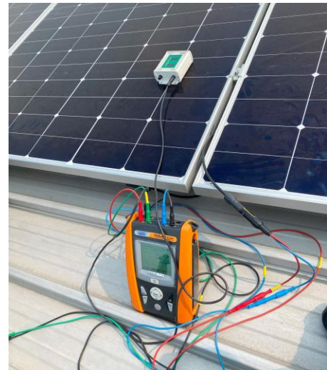
รูปที่ 2 การวัดเส้นโค้ง I-V ของโมดูลเซลล์แสงอาทิตย์ด้วยเครื่องบันทึกเส้นโค้งกระแส-แรงดัน(I-V Curve)
