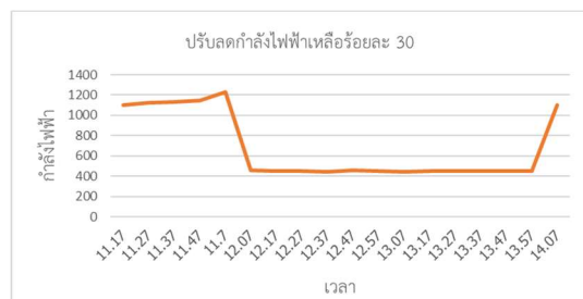
รูปที่ 13 จำกัดกำลังไฟฟ้าที่ร้อยละ 30
