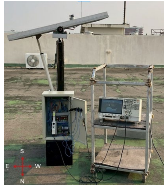
รูปที่ 6 ชิ้นงานชุดติดตามดวงอาทิตย์สำหรับเซลล์แสงอาทิตย์แบบเคลื่อนที่สองแกน
