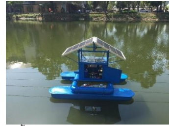
รูปที่ 11 เครื่องรดน้ำร่องสวนผลไม้อัตโนมัติพลังงานแสงอาทิตย์ผ่าน IoT
