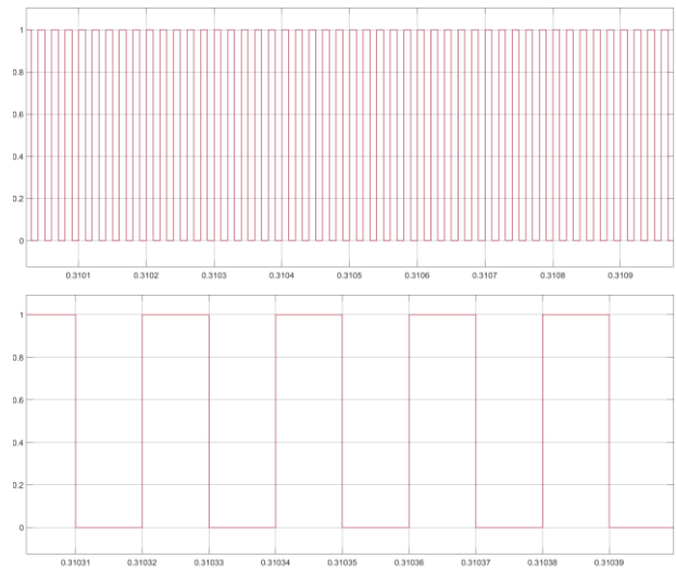
รูปที่ 6 รูปคลื่นพัลส์ที่ใช้ในการควบคุมการทำงานของวงจรเมตริกซ์คอนเวอร์เตอร์หนึ่งเฟสที่ความถี่ 50kHz พร้อมภาพขยาย
