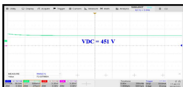
รูปที่ 15 แรงดันที่บัสดีซี (DC link) ในกรณีศึกษา V2V
