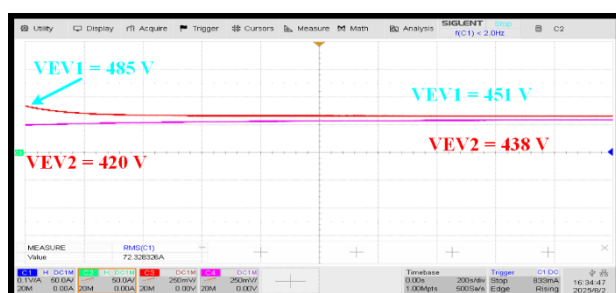
รูปที่ 14 แรงดันไฟฟ้าของยานยนต์ไฟฟ้า EV1 (VEV1) และยานยนต์ไฟฟ้า EV2 (VEV2) ในกรณีศึกษา V2V
