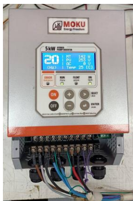
รูปที่ 14 การประกอบแผงวงจรลงกล่องและผลิตภัณฑ์ที่สำเร็จ
