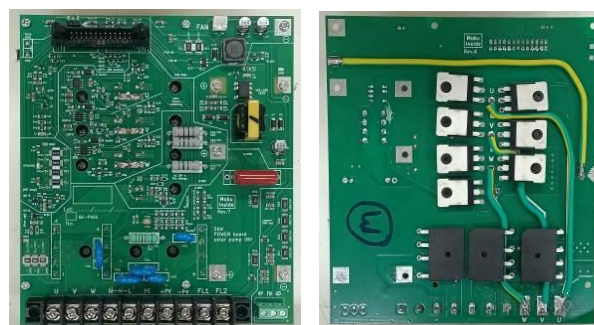
รูปที่ 13 แผงวงจรที่ใช้ IGBT แบบแยกส่วน (หลังปรับปรุง)
