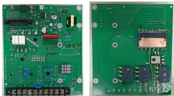
รูปที่ 12 แผงวงจรที่ใช้ IPM (ก่อนปรับปรุง)
