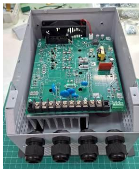
รูปที่ 14 การประกอบแผงวงจรลงกล่องและผลิตภัณฑ์ที่สำเร็จ
