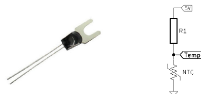
รูปที่ 6 เซ็นเซอร์วัดอุณหภูมิ NTC และการต่อใช้งาน
