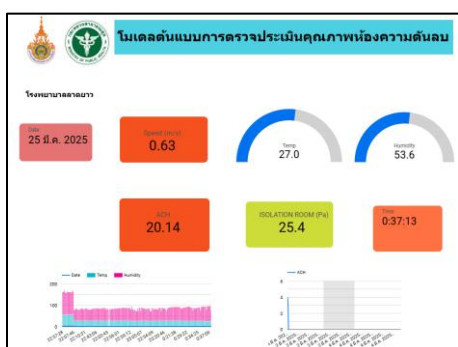
รูปที่ 7 แสดงหน้า Dash board แสดงค่าของเซ็นเซอร์วัดความเร็วลมของห้องแยกโรคผู้ป่วยติดเชื้อทางอากาศ เข้าระบบด้วยชื่อ URL https://lookerstudio.google.com/u/0/reporting/562b6732-b2a1-4763-9995-08f789beadf2/page/PXqCE เพื่อดูข้อมูล
