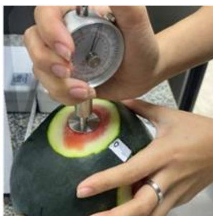
รูปที่ 8 ตัวอย่างการวัดความแน่นของแตงโมด้วยเครื่องวัดความแน่นเนื้อ
