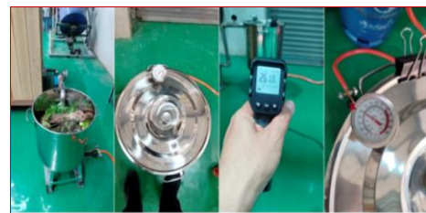
รูปที่ 8 การต้มน้ำสมุนไพรเพื่อผลิตไอน้ำเข้าสู่ห้องอบสมุนไพร
