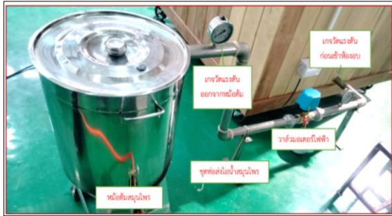
รูปที่ 4 ชุดผลิตไอน้ำสมุนไพร สำหรับต้มน้ำสมุนไพรเพื่อสุขภาพ
