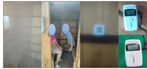
รูปที่ 11 การทดสอบวัดอุณหภูมิภายในห้องอบไอน้ำสมุนไพร
