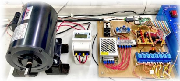
รูปที่ 3 Raspberry Pi และ พาวเวอร์มอเตอร์วัดค่าพลังงานไฟฟ้าสำหรับการจำลองกระบวนการผลิต
