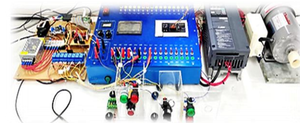
รูปที่ 2 PLC, HMI และอินเวอร์เตอร์ที่ใช้จำลองการทำงานของเครื่องจักร
