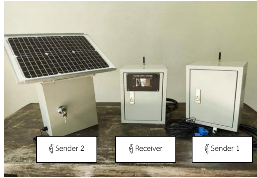
รูปที่ 2 ตู้ควบคุมระบบติดตามและแจ้งเตือนระดับน้ำในกระบวนการผลิตน้ำประปา
