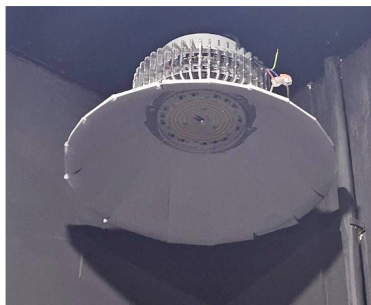
รูปที่ 5 ดวงโคมที่มีพื้นผิวภายในเรียบ
