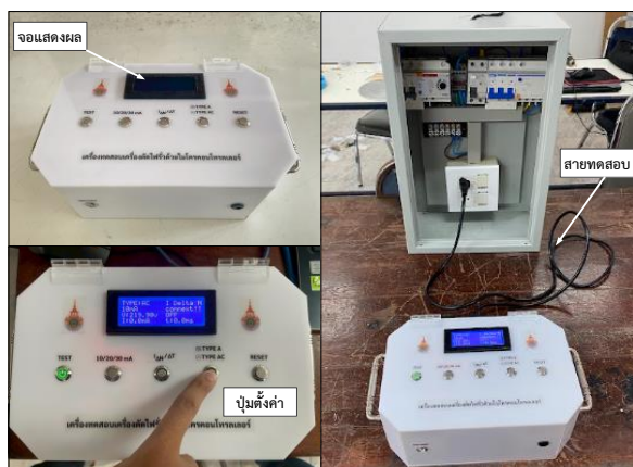
รูปที่ 3 เครื่องทดสอบอุปกรณ์ตัดไฟรั่วด้วยไมโครคอนโทรลเลอร์
