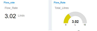
(ค) แสดงผลบนNetpie ด้วยปริมาณน้ำ 3 ลิตร รูปที่ 5 แสดงการทดลองวัดอัตราการไหลน้ำทั้ง 3 ระดับ
