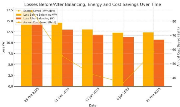
รูปที่ 8 การเปรียบเทียบการสูญเสียพลังงานก่อนและหลังการปรับสมดุล พร้อมการประหยัดพลังงานและต้นทุนรายปี
