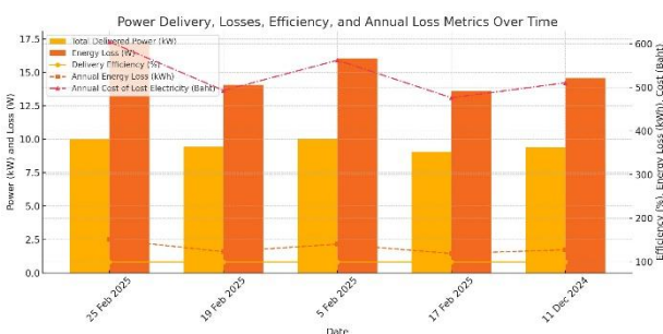
รูปที่ 7 การส่งจ่ายกำลังไฟฟ้า การสูญเสีย ประสิทธิภาพ และตัววัดการสูญเสียรายปีตามช่วงเวลา
