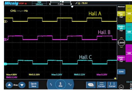
รูปที่ 10 สัญญาณ Hall Sensor ของมอเตอร์แบบ 120 องศา
