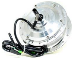
รูปที่ 1 มอเตอร์คูล์ (Hub Motor) ขนาด 36 โวลต์ 350 วัตต์
