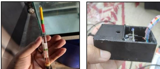
รูปที่ 1 การดัดแปลงไฮโดรมิเตอร์เพื่อใช้กับเซนเซอร์แยกสี
