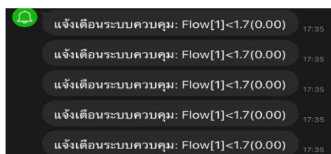
รูปที่ 18 การแจ้งเตือนการอุดตันของระบบกรองของเสียในน้ำ
