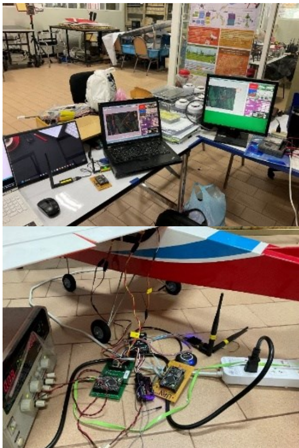
รูปที่ 7 การทดสอบการทดสอบสัญญาณของระบบควบคุมที่มีระบบทวนสัญญาณในห้องปฏิบัติการ
