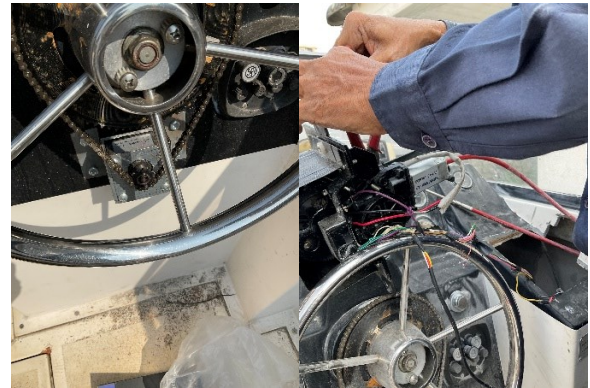
รูปที่ 4 การติดตั้งดิซีมอเตอร์สำหรับการควบคุมพวงมาลัยบังคับทางเสือเรือ และดิซีมอเตอร์ควบคุมคันเร่งความเร็ว
