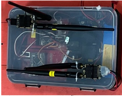
รูปที่ 6 กล่องควบคุมต้นแบบที่ติดตั้งบนเรือไร้คนขับระยะไกล
