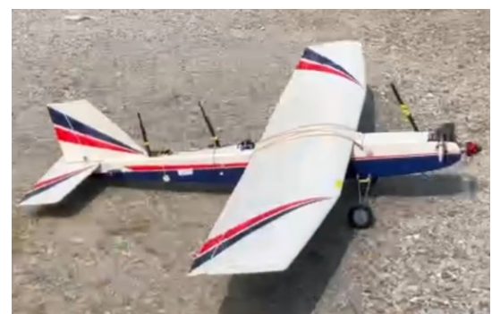
รูปที่ 9 อากาศยานไร้คนขับ (Relaying UAV) ที่ใช้บินถ่ายทอดสัญญาณ
