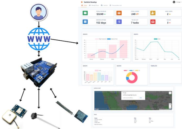
รูปที่ 3 ระบบติดตามด้วยจีพีเอสและอุปกรณ์ตรวจสอบระดับน้ำมันด้วย การประมวลผลตามเวลาจริง
