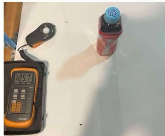
รูปที่ 7 ตัวอย่างการวางเครื่องมือวัดแสง (Lux Meter)
