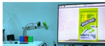
รูปที่ 8 การทดลองแขนหุ่นยนต์หยิบจับและวางวัตถุสีต่างจากสีที่กำหนด
