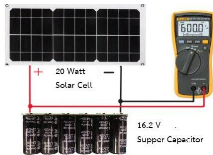
รูปที่ 9 การต่อแผงโซลาร์เซลล์กับซูเปอร์คาปาซิเตอร์
