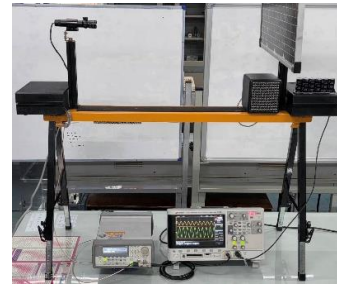
รูปที่ 10 ชุดอุปกรณ์ทดลองการส่งและรับสัญญาณเสียงที่มอดูเลตกับแสงเลเซอร์ประกอบลงแท่นเพื่อความเรียบร้อย
