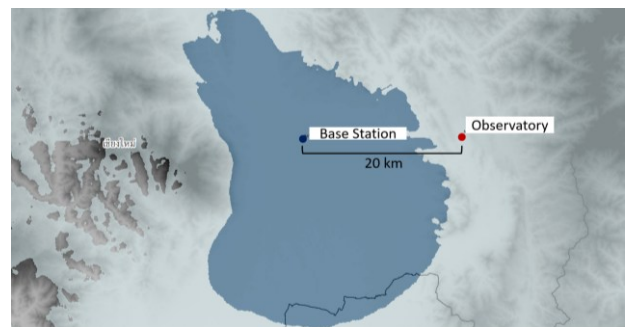
รูปที่ 5 ผลการจำลองขอบเขตของการแพร่สัญญาณระบบโทรศัพท์เคลื่อนที่ ย่าน 1427-1432 MHz ไปยังความถี่ 1400-1427 MHz ในระยะที่ก่อให้เกิดการรบกวนต่อภาครับของกล้องโทรทรรศน์วิทยุได้ ผ่านโปรแกรม PROGIRA
